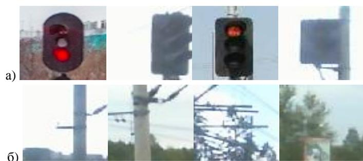
Рис. 1. Примеры тестовых изображений из базы: а) изображения с объектом интереса (положительная выборка); б) изображения без объекта интереса (отрицательная выборка)
