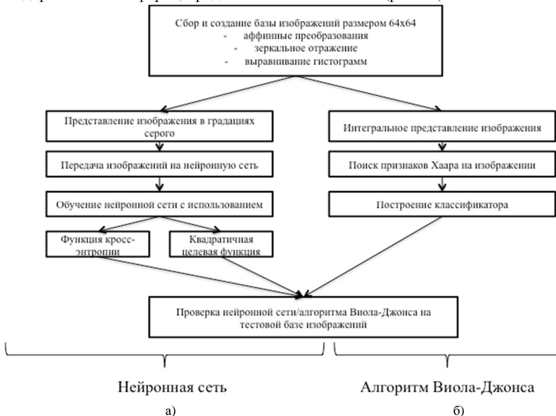
Рис. 3. Детектирование с применением: а) нейронной сети; б) алгоритма Виола-Джонса
